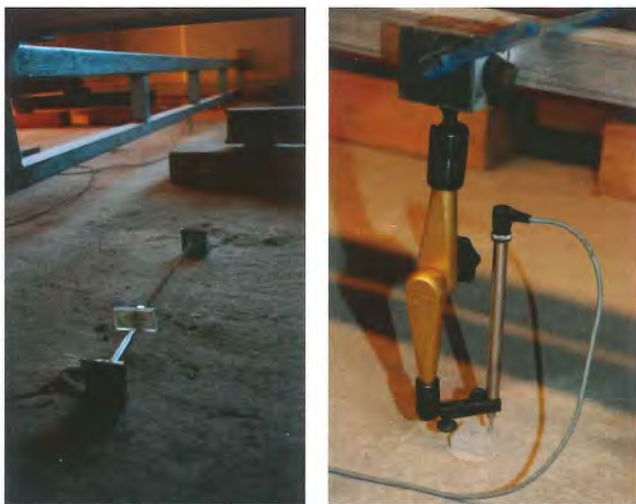
Abb. 19 (links): Messung der Betonstauchung an der Deckenoberseite; (rechts): Messung der Durchbiegung im Feld an der Deckenoberseite
